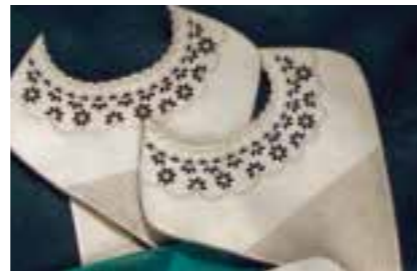
Marcação e gravação em gáspeas em pele Marking and engraving on leather uppers
