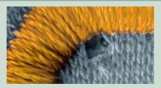
Se a ponta da agulha estiver muito cortante ou danificada, as linhas da malha são picadas e rompem. Se a espessura da agulha for espessa demais, as malhas são alongadas excessivamente e arrebentam.
