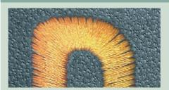
Mediante o uso de uma ponta de corte, o couro é cortado em sentido longitudinal e transversal de formas diferentes. Em casos extremos pode dar-se o seccionamento do couro.
