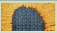
Foi possível bordar este artigo de malha delicado sem danos e de modo preciso com o uso do sistema de agulhas DB x K5 Nm 65 com ponta RG.
